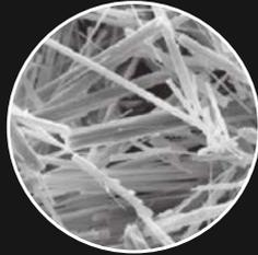
Estructura cristalina del sulfato de calcio α - hemi - hidrato
