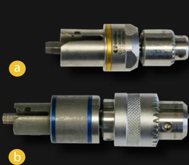
Dos MODELOS de anclajes tipo jacob: superior velocidad de rotación (a) y superior para torque (b).
